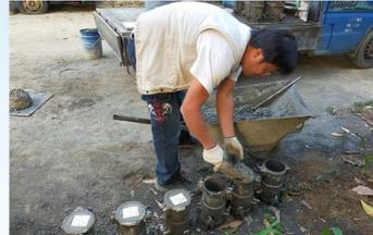
混凝土圓柱試體製作
